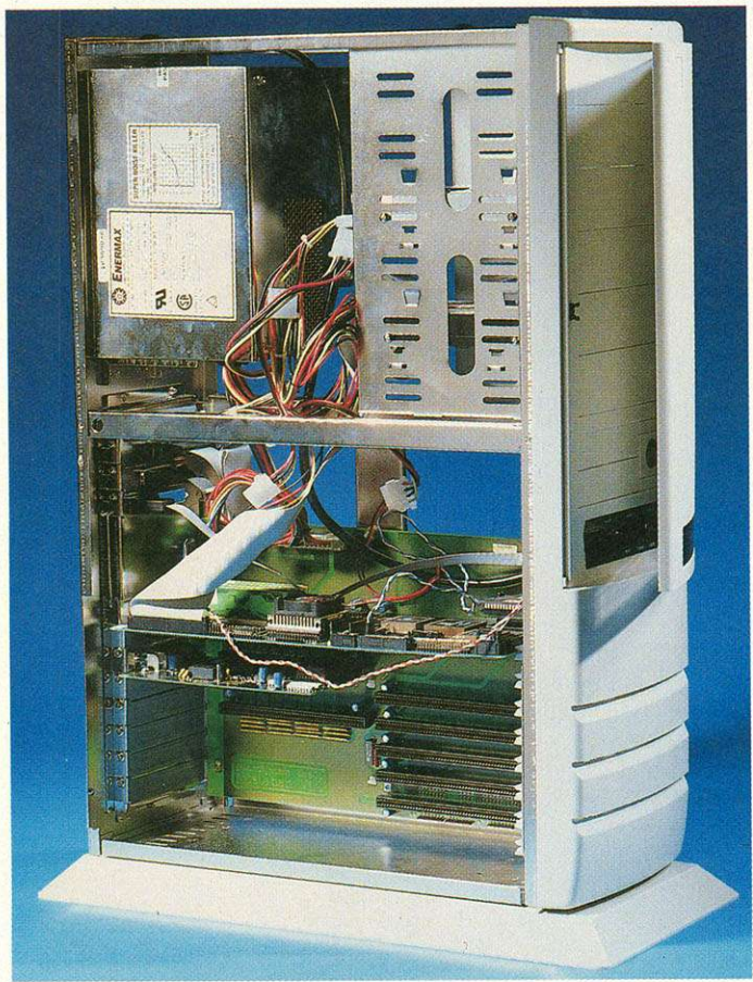
Neue Hülle, neuer Inhalt: DraCo läuft mit Amiga-OS und 68060-CPU, aber ohne Custom-Chips. Im ersten Bericht sehen Sie, was in dem neuen Rechner steckt. ab Seite 12
