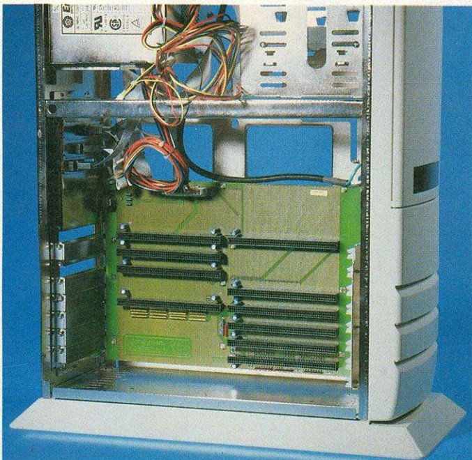
Steckplätze: Oben der Platz für die Prozessorkarte, darunter drei DraCo-Direkt-Slots und fünf Zorro-II-Leisten
